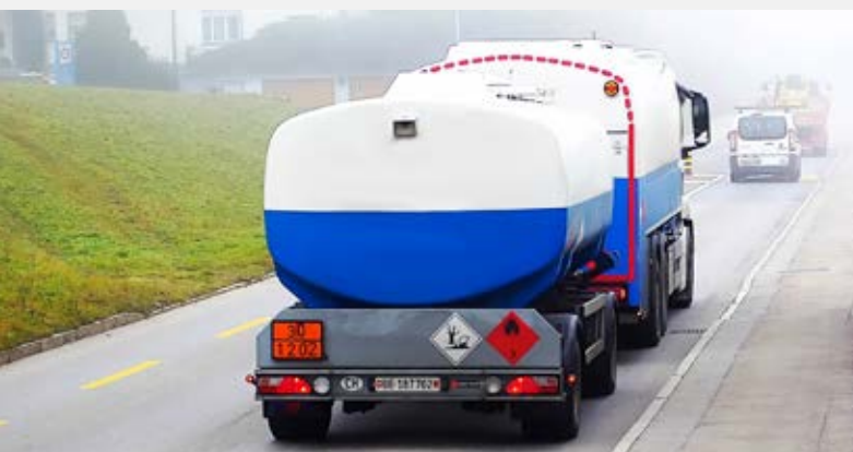
Gefahrguttransport in der Schweiz mit Kennzeichnung der Ladung durch eine orange Plakette.
