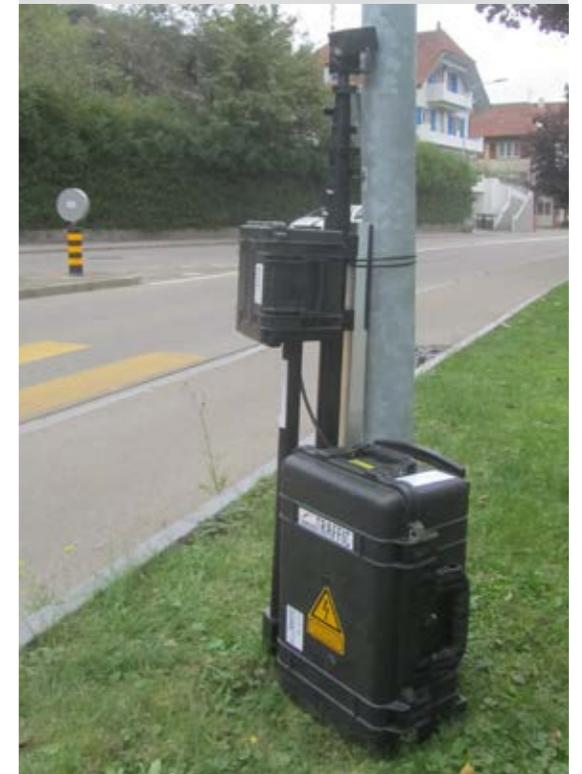
Système de caméra temporaire équipé d'un logiciel d'analyse avec AI pour les évaluations en temps réel et la représentation le tableau de bord approprié.
