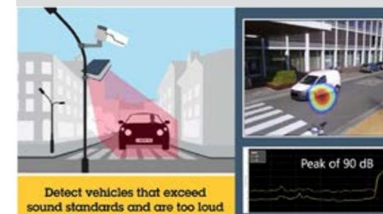
Il détecte les véhicules trop bruyants et peut représenter la position exacte de la source de bruit dans une courte vidéo à titre de preuve. Seuls les véhicules trop bruyants font l'objet d'une courte vidéo et d'un enregistrement automatique de leur numéro de plaque d'immatriculation. Un tableau de bord clair présente en outre le bruit de tous les véhicules sur la section de la route.
