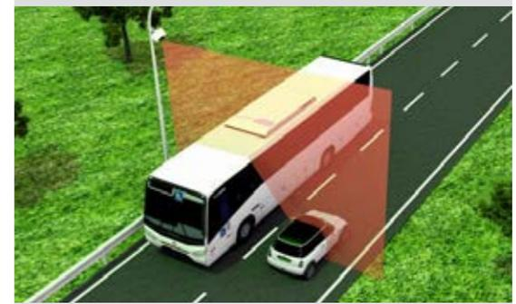
Si la hauteur d'installation est d'env. 8 mètres, 2 voies peuvent être couvertes simultanément.
