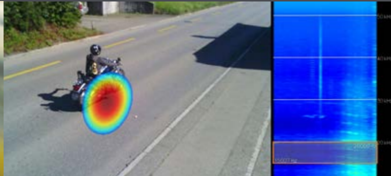
Détection et détermination du bruit à la source.
