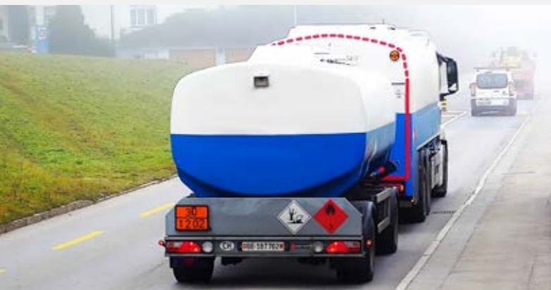
Transport de Matières Dangereuses en Suisse avec l'indication de la cargaison par une plaque orange.
