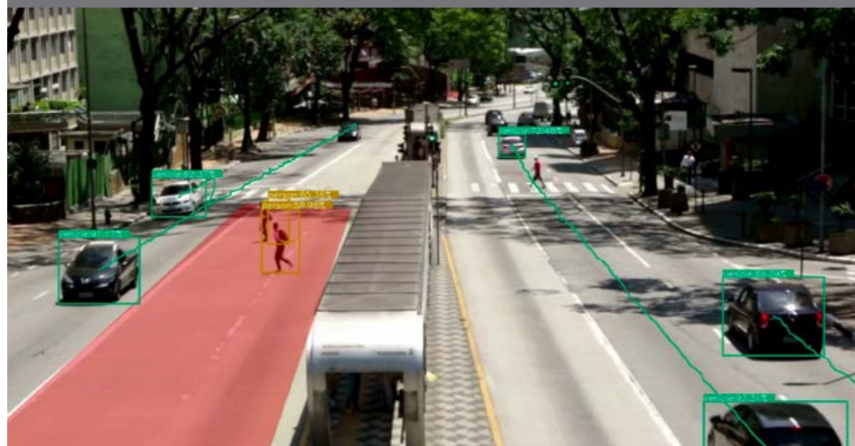
Détection d'une situation dangereuse. Analyse automatique pour déterminer s'il s'agit d'un presque-accident.
