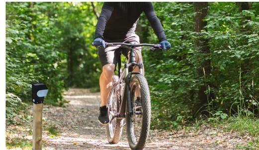
Largeur de comptage par capteur : 1 à 6 mètres. Largeur idéale : 3 mètres, pour garantir une précision supérieure à 95 %. Si la largeur est supérieure à 3 mètres, la précision tombe à 90%.
