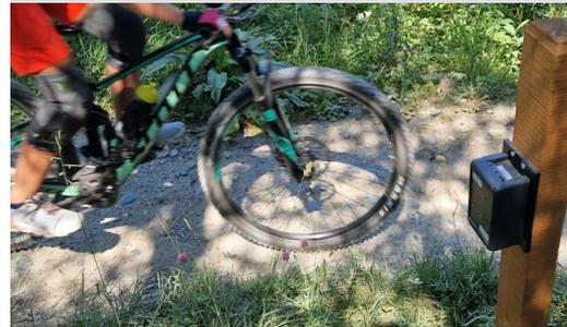
Peut être installé au bord d'un sentier (1 capteur intégré dans un poteau en bois).
